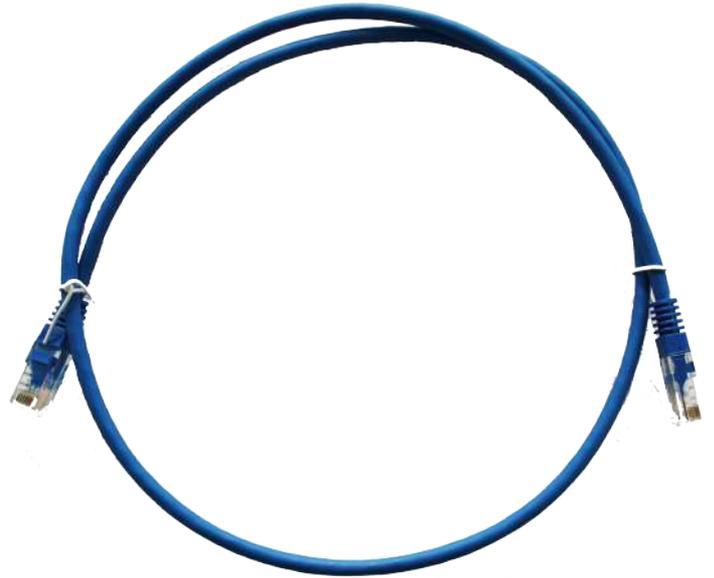
Los Patch Cords categoría 5e de Net-Link, están contruidos con un conductor 100% cobre de máxima calidad, distribuido en 4 pares trenzados con un aislante de polietileno de alta calidad, y separados con un divisor de cuadrante.
