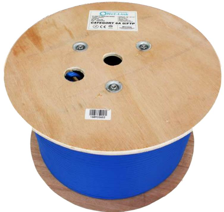
El cable categoría 6A U/FTP de Net-Link, está compuesto de un material 100% de cobre, con un calibre 23 AWG que está cubierto por un aislante de polietileno de alta densidad (HDPE) retardante de llama, dispuesto en 4 pares trenzados, y con un divisor de pares integrado, con una chaqueta baja en emisión de humos y sin halógenos LSFRZH.
