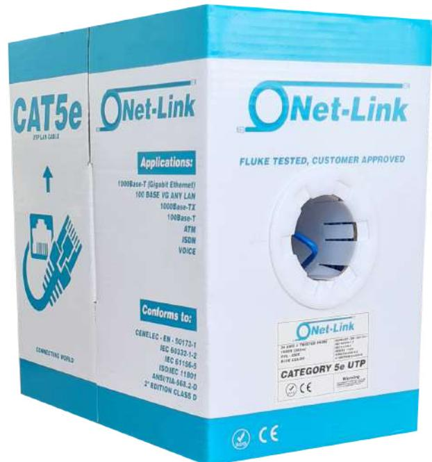
El cable categoría 5e UTP de Net-Link, está compuesto de un material 100% de cobre, con un calibre 24 AWG que está cubierto por un aislante de polietileno de alta densidad (HDPE) retardante de llama, dispuesto en 4 pares trenzados, y con una chaqueta de comunicaciones multipropósito.
